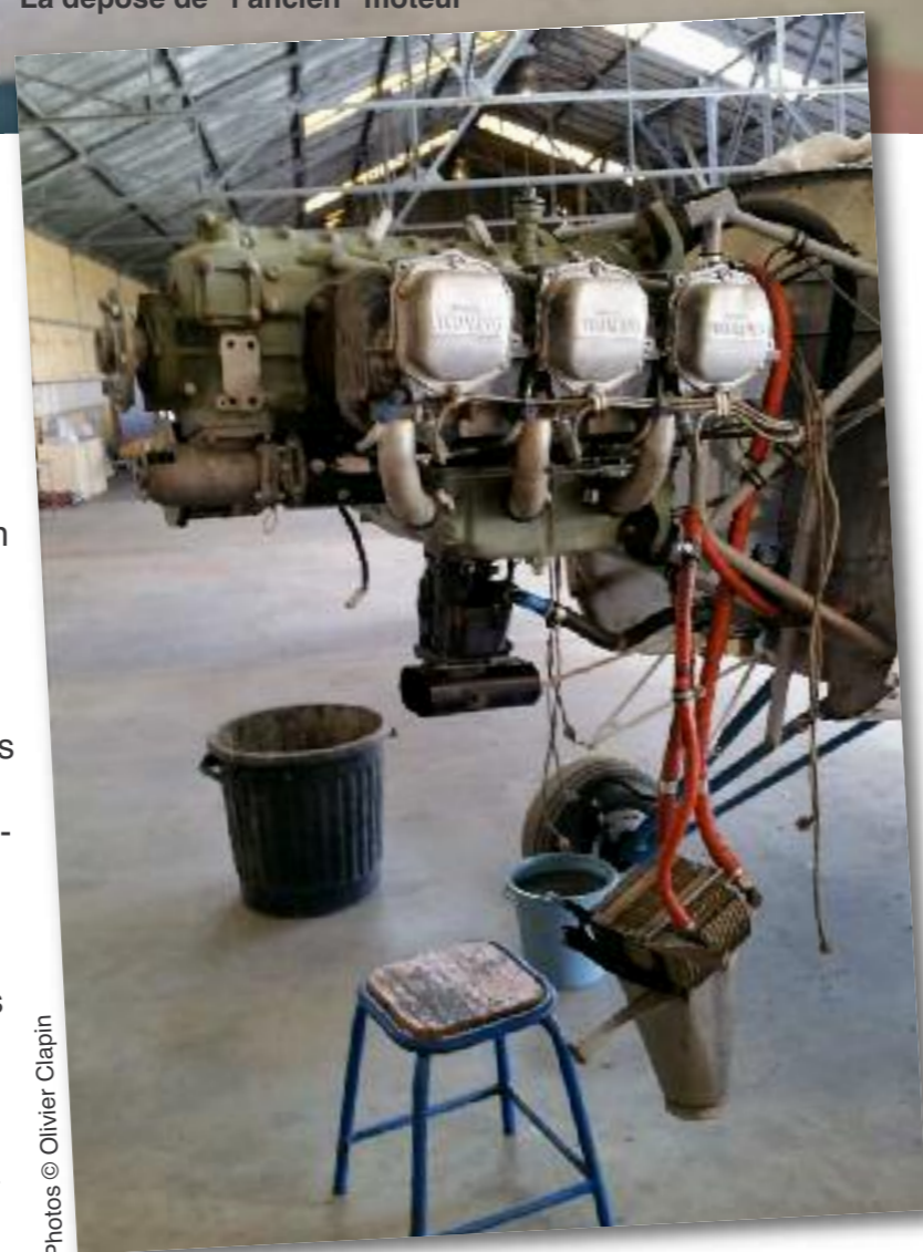
La dépose de "l'ancien" moteur
