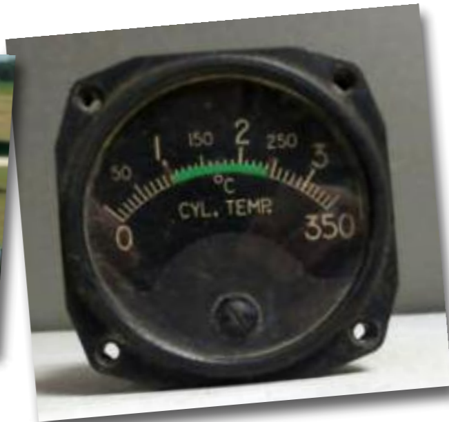
Vérifier les 9 quarts d'huile ! 150°C minimum aux cylindres avant de rouler...
