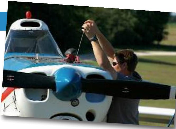
Vérifier les 9 quarts d'huile ! 150°C minimum aux cylindres avant de rouler...
