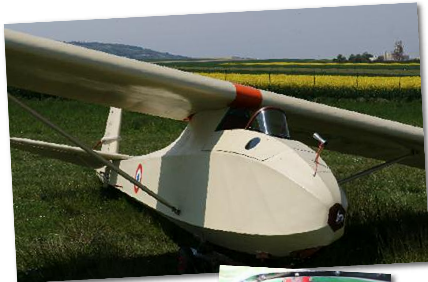
Cockpit torpédo pour le Nord 1300, construit par la Société nationale des constructions aéronautiques du Nord (SNCAN). C'est la version française du Grunau Baby (1931) construit à plus de 6.000 exemplaires...
