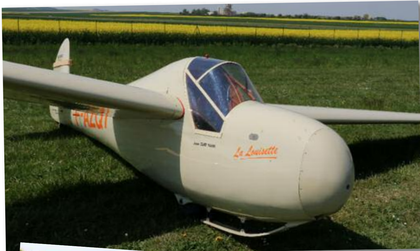
Unique... le prototype du Breguet 900-01, baptisé "La Louisette" (Louis Breguet...). Ce planeur rappellera quelques souvenirs aux "anciens" de Buno car il a volé à partir du terrain de La Ferté-Alais. Premier vol en juin 1948. 8 exemplaires construits avant de passer au Breguet 901.
